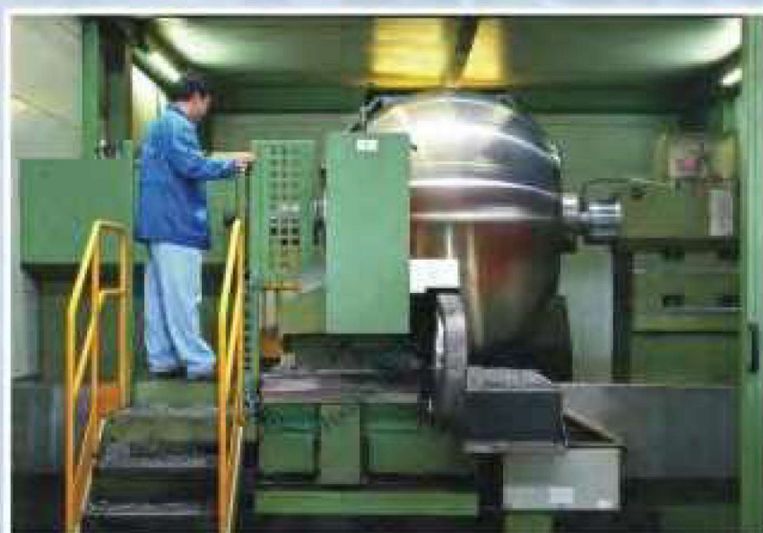
车/磨一体化数控球机正在加工48" 球体
