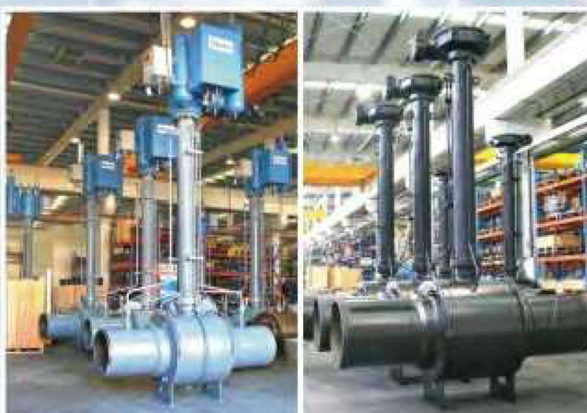
26" 和28" 接长杆全焊接球阀
