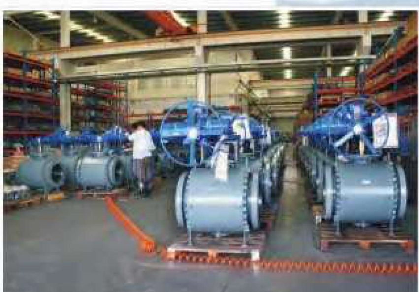
电动管线球阀正在调试中
