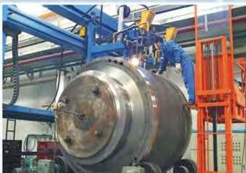
48" 900级全焊接球阀正在焊接主焊缝
